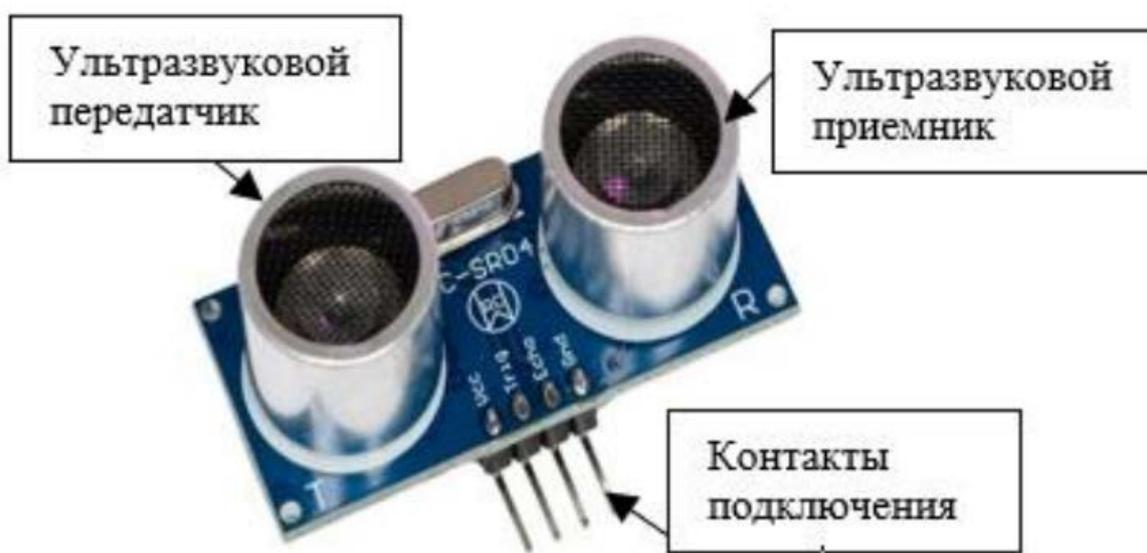
Рисунок 4 – Ультразвуковой датчик
