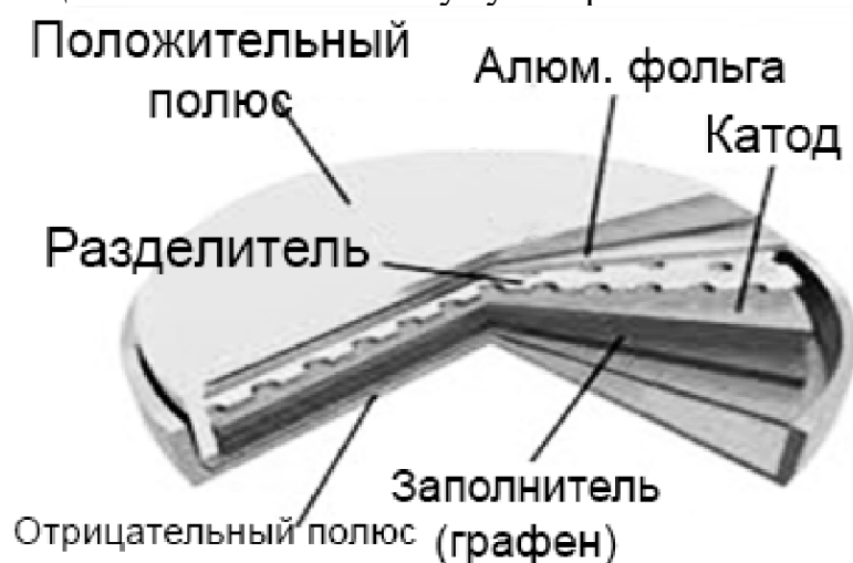
Рисунок 2 – Схематическое устройство аккумулятора на базе графена
