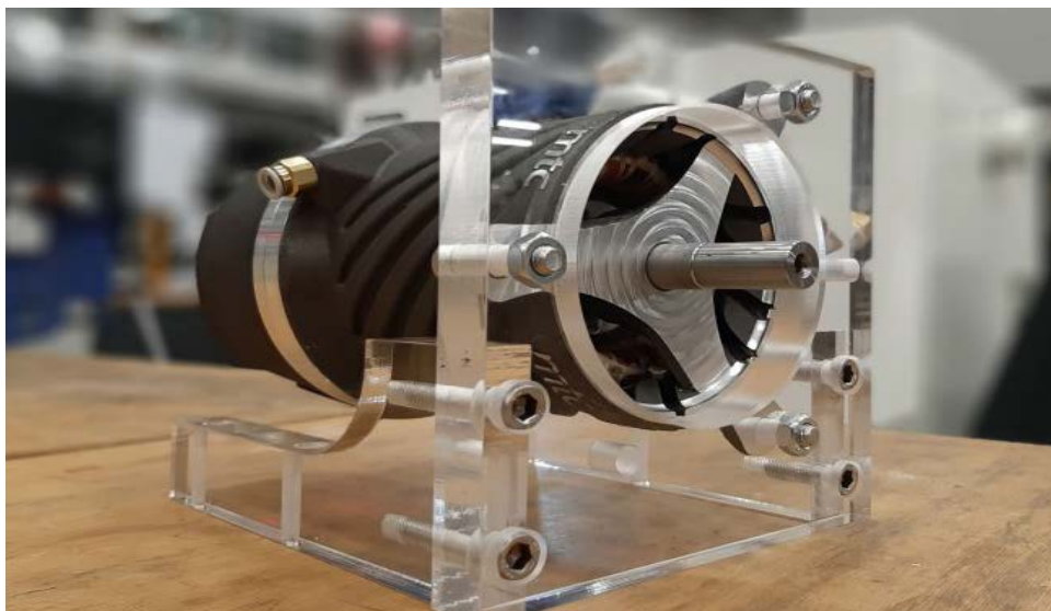
Рисунок 4 – Электродвигатель, изготовленный из компонентов, напечатанных на 3D-принтере.
