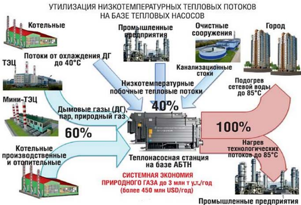
Рисунок 3 – Принципиальная схема теплоснабжения промышленных узлов с использованием тепловых ВЭР и ожидаемый эффект от ее реализации в Беларуси
