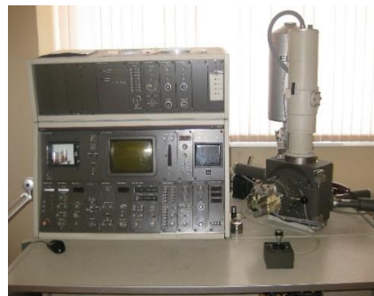
Рисунок 3 – Сканирующий электронный микроскоп SEM 515 с приставкой для микроанализа
