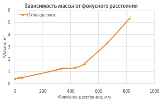
Рисунок 2 – Зависимость массы от фокусного расстояния у охлаждаемых тепловизионных каналов
