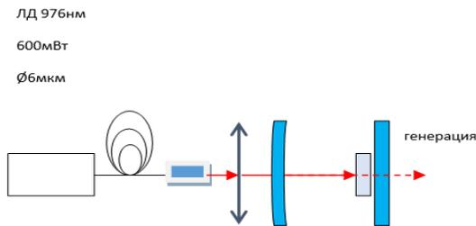
Рисунок 1 – Схема экспериментальной установки непрерывного лазера на основе кристалла  $\text{Yb}^{3+}:\text{KY}(\text{WO}_4)_2$
