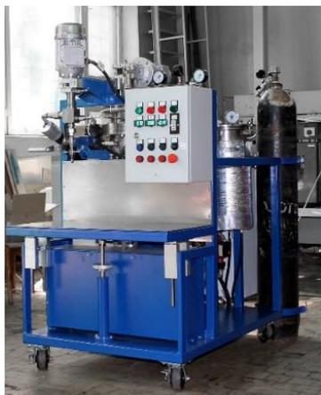
Рисунок 1 – Машина для импульсной заливки полимерных двухкомпонентных эпоксидных систем
