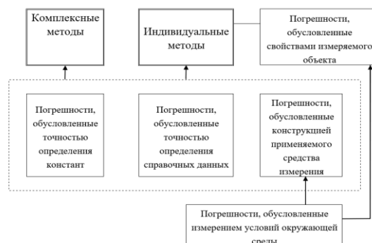
Рисунок 1 – Классификационная схема источников погрешностей для различных типов средств измерений, используемых для наночастиц, находящихся на подложке, в жидкости и воздухе
