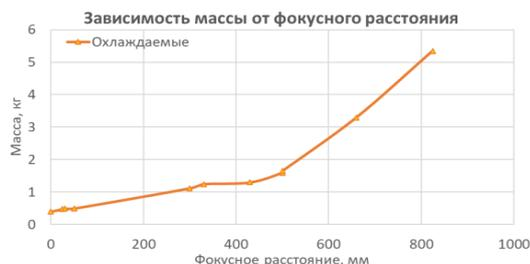
Рисунок 2 – Зависимость массы от фокусного расстояния у охлаждаемых тепловизионных каналов
