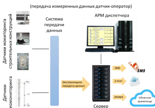
Рисунок 1 – Типовая структура системы автоматизированного мониторинга высотного здания
