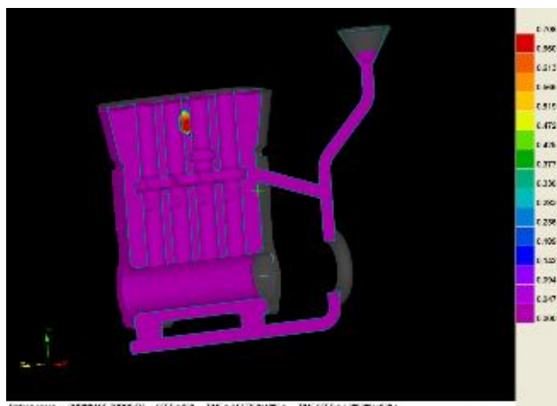
Рис. 5 – Вероятность формирования усадочных дефектов (пористости) в отливке из сплава АК9 с использованием расчетных данных ProCAST
