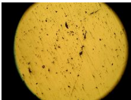
Рисунок 2 – Микроструктура продольного шлифа в зоне максимального загрязнения неметаллическими включениями x100
