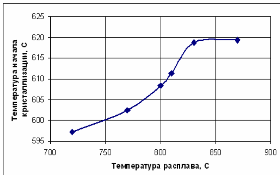
Рисунок 1 - Зависимость температуры начала кристаллизации сплава Al-16%Si от температуры перегрева сплава в жидком состоянии
