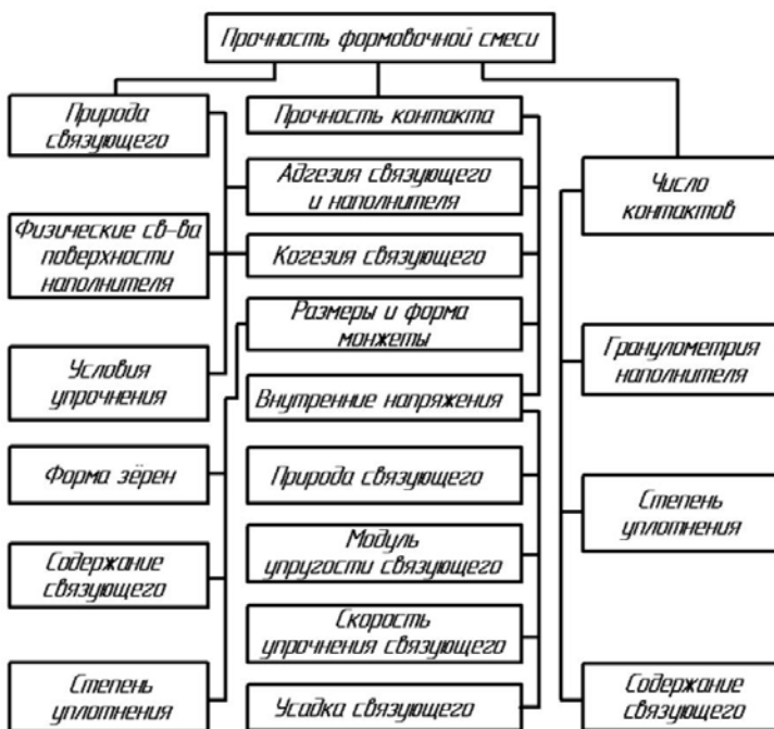
Рис. 1.4. Факторы, влияющие на прочность формовочных смесей
