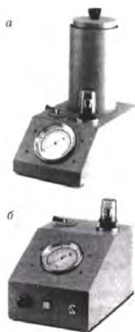
Рис. 7.13 Прибор для определения газопроницаемости формовочных и стержневых смесей: а) механический; б) электронный
