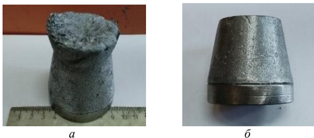
Рисунок 3 – Фотографии промышленного образца составного катода-мишени, полученного двойным переплавом титансодержащего сплава: а – литая заготовка; б – образец промышленного составного катода
