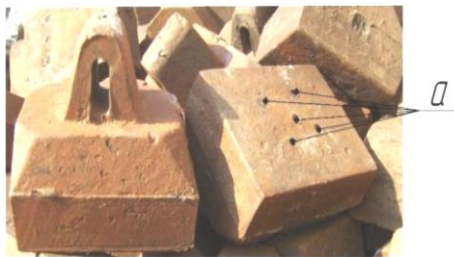
Рисунок 6 – Отливки «Башмак», полученные с помощью (внутренних) металлических холодильников из ИЧХ280Х29НЛ, a – внутренние холодильники
