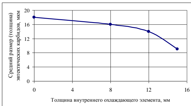
Рисунок 5 – Зависимость размера эвтектических карбидов от диаметра внутренних холодильников
