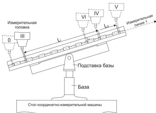
Рисунок 4 – Шаговый калибр, расположенный наклонно в трех измерениях на столе КИМ (координатно-измерительная машина), показывающий измерение внутреннего размера L_i , внешнего размера L_e или позиционный L_p лицевой стороны калибра как расстояние от базовой стороны
