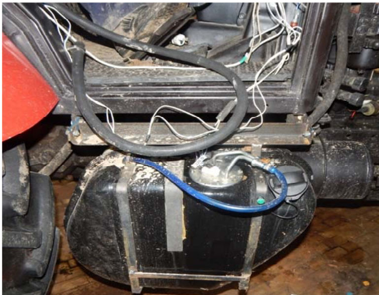
Рисунок 1 – Система питания с дополнительным топливным баком
