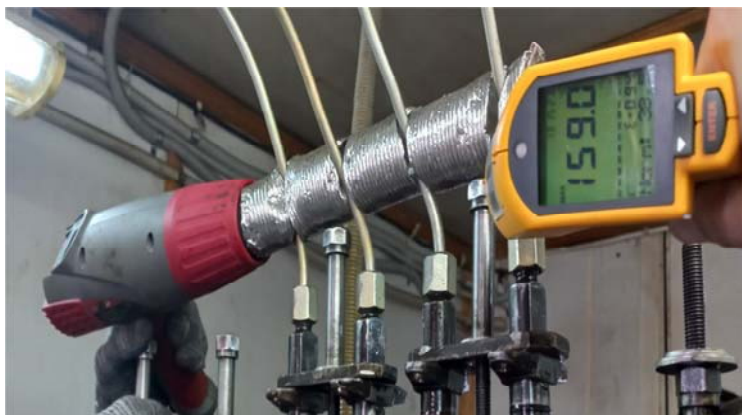
Рисунок 1 – Способ подогрева топливопроводов высокого давления
