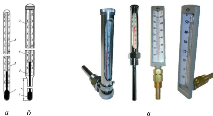
Рис. 1. Жидкостные стеклянные термометры: а – палочный; б – технический со сложной шкалой; в – технические термометры
