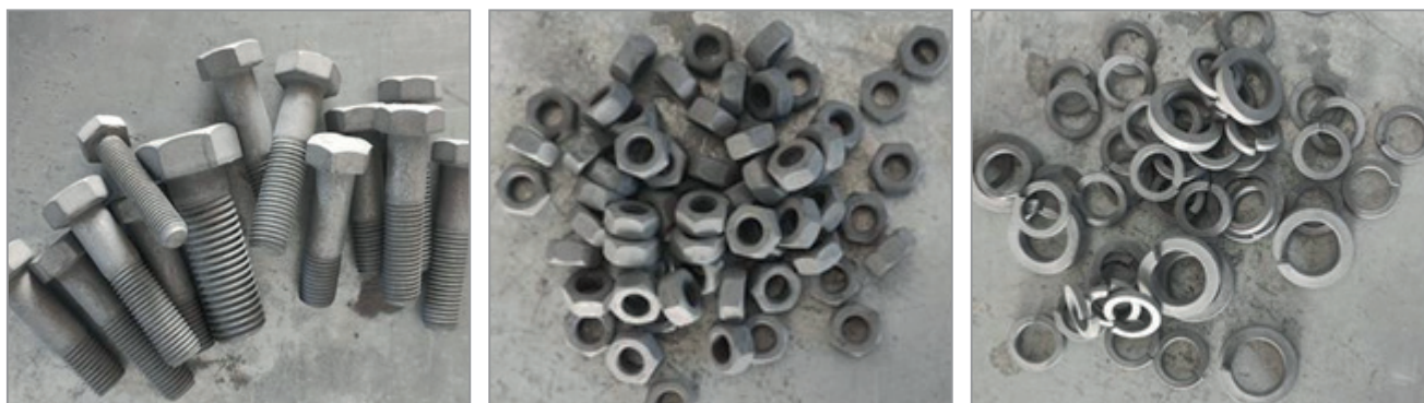
Рис. 2. Внешний вид стальных изделий, оцинкованных методом термодиффузионного насыщения: а – болты; б – гайки; в – шайбы
