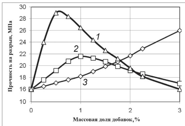
Рис 4. Влияние легирующих добавок на прочность на разрыв ППМ, изготовленных из титанового губчатого порошка марки ТПП-5 (размер частиц 630–1000 мкм): 1 – TiH 2 ; 2 – ZnO; 3 – Al
