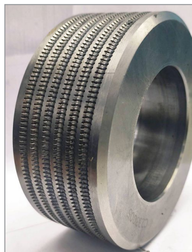
Рис. 2. Твердосплавные ролики для производства проволоки класса Вр-1
