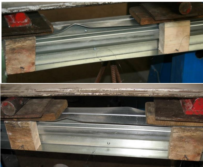
Рисунок 1 – Потеря местной устойчивости сжатого пояса профиля без элементов жесткости при изгибе
