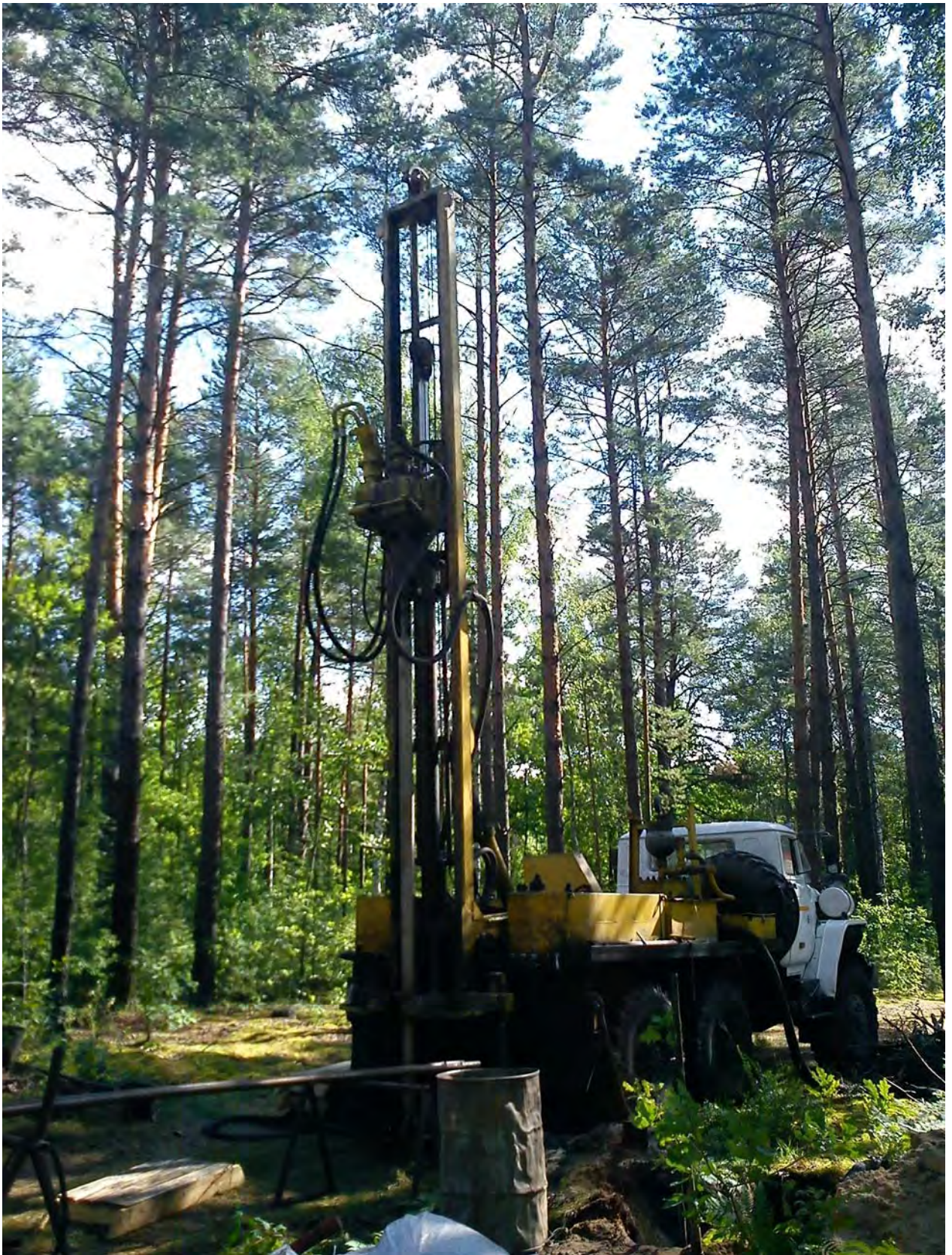
Рис. 15. Буровая установка с подвижным вращателем (с гидроприводом вращателя) УРБ2А2
