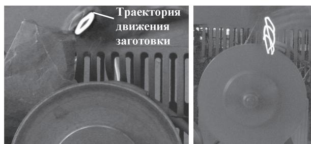
Рисунок 2 — Траектория движения точки, принадлежащей заготовке:
