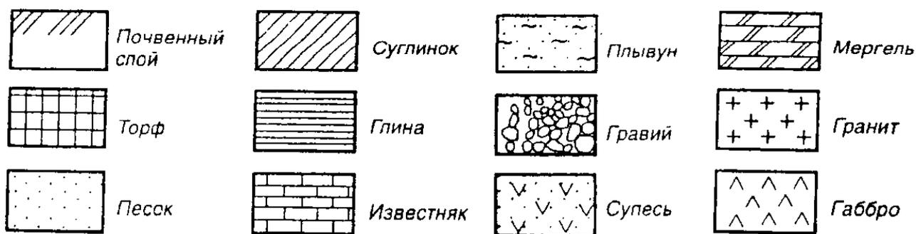
**Рис. 79.** Условные обозначения пород для литологических разрезов и карт
