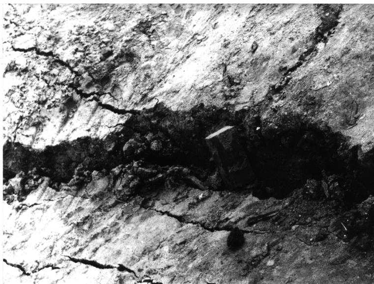
**Рис. 40.** Оползневые трещины на поверхности грунта
