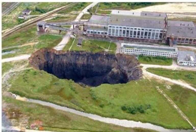
Рис.17. Провал грунта на территории завода «Уралкалий»
