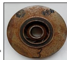
Рис. 7. Рабочее колесо насоса 5А-35 (3-й образец)
