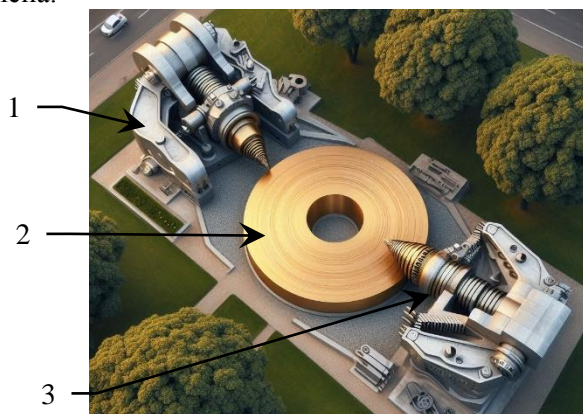
Рисунок 2 – III-интерпретация концепции вертикально-токарного (карусельного) станка: 1 – стойка-башня; 2 – обрабатываемая деталь типа диска; 3 – обобщенная обрабатывающая головка
