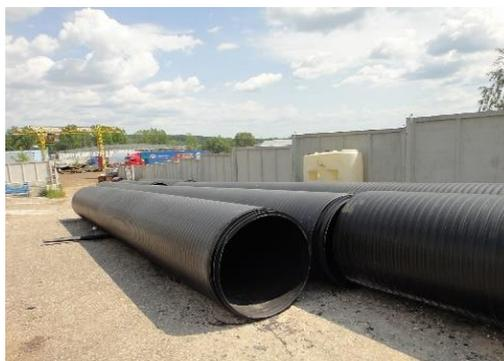
**Рис.5. Трубы спиральновитые для безнапорных систем**
