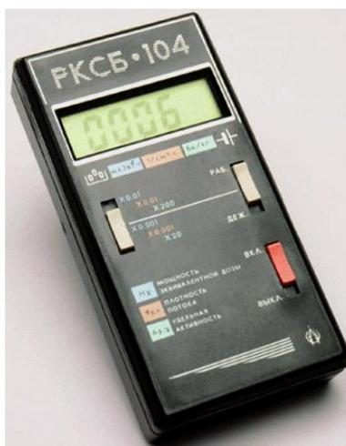
**Рис.1 – Внешний вид прибора РКСБ-104**
