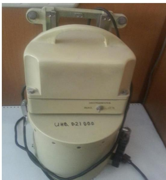
*Рис.4 – Блок обработки проб*
