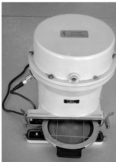
*Рис.2 – Блок детектирования  $\alpha$  излучения*
