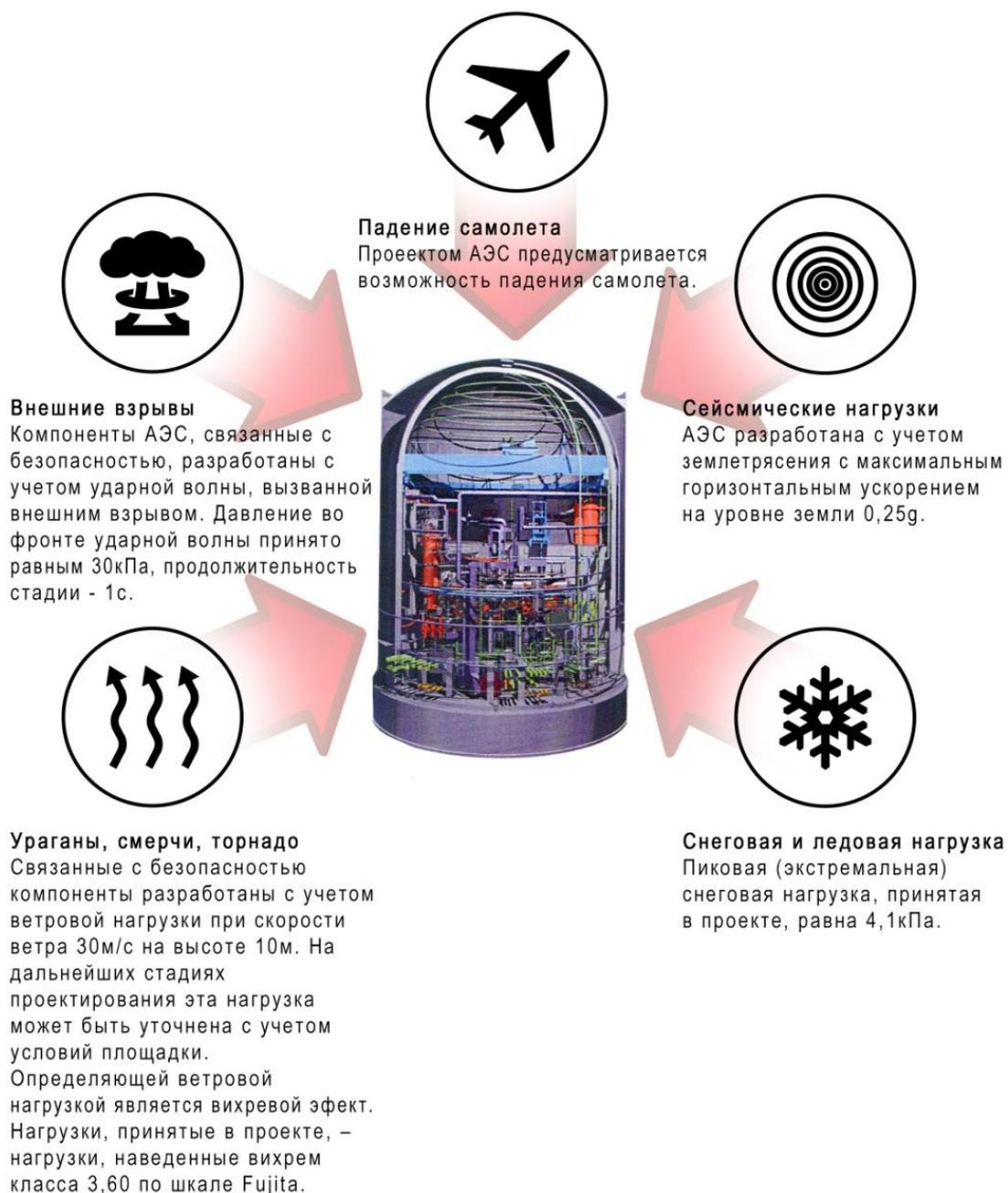
*Рис. 16.3 – Защита здания АЭС от внешних воздействий*
