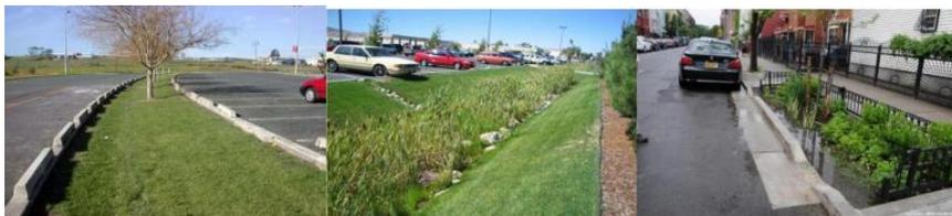
**Рис.2. Применение биофильтрационного склона, биодренажного канала, дождевого сада [7]**
