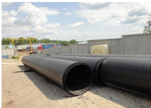
**Рис.5. Трубы спиральновитые для безнапорных систем**
