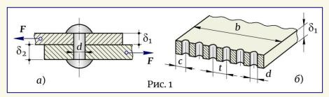
Для удобства установки заклепок расстояние между ними и от края листа регламентируется: шаг в ряду (расстояние между центрами заклепок) принимается t = 3d; расстояние до края — c = 1.5d (рис. 1,  $\delta$ ).
