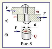
где  $A_{\rm cpe3}$  – площадь среза, для круглого сечения равная: а условие прочности заклепки на срез имеет вид:
