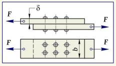
емых растягивающих усилий, если для элементов соединения  $\left[\tau\right]_{cpe3}$  = 120 МПа,  $\left[\sigma\right]_{cm}$  = 320 МПа,  $\left[\sigma\right]_{pact}$  = 160 МПа.
