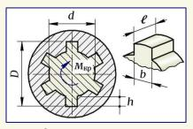
Принять для соединения: D = 32 мм; d = 26 мм; b = 4 мм;  $\ell = 30$  мм.
