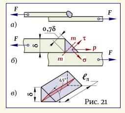
чение "m-m", имеющее в угловом шве (без учета наплывов) наименьшую площадь, принимаемую за расчетную и равную:
