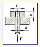
1 Определяем силу "F", растягивающую болт:
