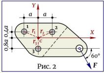
② В полученной системе координат X - Y (рис. 2) по заданному положению заклепок и формуле  $r_i = \sqrt{{x_i}^2 + {y_i}^2}$  определяем значение радиус-вектора соответствующей заклепки:
