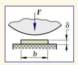
Из условия разрушения на срез определяем силу "F", необходимую для разрезания листа:
