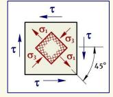
⋆ Главные линейные деформации, согласно обобщенному закону Гука, при чистом сдвиге определяются как —
