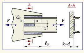
стенки швеллера. Длина и ширина прорезного шва соответственно равны  $\ell_{\Pi p} = 20\,\mathrm{cm}$  и  $a = 20\,\mathrm{mm}$ . Проверить прочность соединения, если для швеллера  $\left[\sigma\right]_{\mathrm{pact}} = 160\,\mathrm{M\Pi a}$ , а для материала шва  $\left[\tau_{\Im}\right] = 100\,\mathrm{M\Pi a}$ . По таблицам сортамента принять для швеллера:  $A = 40,5\,\mathrm{cm}^2$ ,  $d = 6,5\,\mathrm{mm}$ . Швы считать выполненными с полным проваром по длине.
