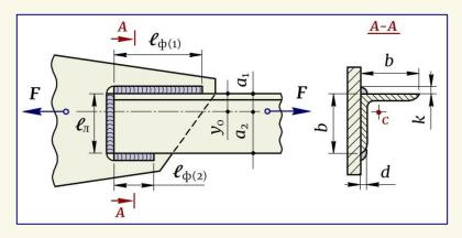
② Из условия прочности на срез, учитывая равнопрочность швов и уголка, определяем суммарную длину лобового и фланговых швов:
