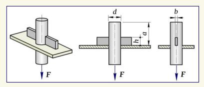
② Под давлением чеки в хвостовике стержня возникает вероятность среза, а также возможен срез самой чеки по двум плоскостям. Учитывая, что стержень и чека имеют одинаковое значение  $[\tau]_{\text{срез}}$ , записываем для них условие прочности на срез —
