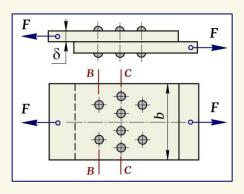
клепочные отверстия понижают прочность листов. Принять для материала заклепок и листов:  $\left[\tau\right]_{cpe3} = 80 \, \text{М}\Pi a, \\ \left[\sigma\right]_{cm} = 240 \, \text{M}\Pi a, \\ \left[\sigma\right]_{pact} = 120 \, \text{M}\Pi a.$
