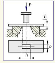
1 Определяем силу, необходимую для пробивки в листе прямоугольного отверстия. Полная площадь среза пробиваемого отверстия
