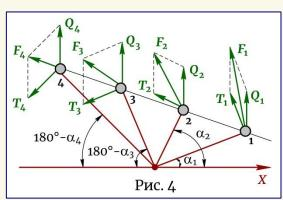
Наиболее нагруженными являются симметрично расположенные заклепки 1-1, где действует наибольшая сила —  $\overline{F_{\text{max}}} = F_1 = 0,283 F$ .
