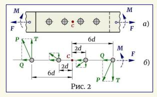
⋆ Поперечную силу "Q" (рис. 2, δ), равномерно распределенную по сечениям заклепок и равную —
