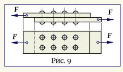
двухрядные, многорядные и др. Как показывают исследования, в многозаклепочных соединениях заклепки в процессе работы нагружены неодинаково и подвергаются действию сил различной величины, однако к моменту их разрушения за счет возникающих пласти-
