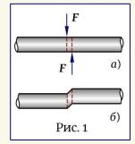
Деформация сдвига, доведенная до разрушения материала, для металлов называется СРЕЗОМ, для неметаллов – СКАЛЫВАНИЕМ.
