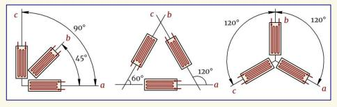
Из теории деформированного состояния известно, что при плоском напряженном состоянии деформации в площадках, повернутых относительно исходных на угол  $\alpha$ , определяются по формуле—
