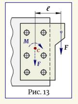
детали абсолютно жесткими и недеформируемыми в плоскости соединения и принимая, что трение между ними отсутствует, а вся внешняя нагрузка передается только через заклепки, взаимный поворот деталей будет происходить вокруг центра заклепочного узла "С", называемого также центром вращения. При таком нагружении сила является внецентренной, и чтобы установить ее действие на соединение, ее
