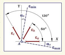
нений определим деформации  $\epsilon_{x}$ ,  $\epsilon_{y}$  и  $\gamma_{xy}$ , принимая углы положения датчиков в системе координат X-Y соответственно равными
