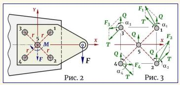
★ Центральная сила "F" создает в сечениях реактивные поперечные силы, одинаковые во всех заклепках (рис. 3) и равные —
