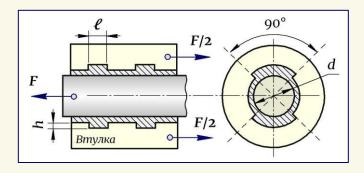
① Выступы работают на срез и на смятие. Срез происходит по четверти цилиндрической поверхности площадью —
