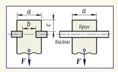
$b = 12 \, \text{cm}$ . Определить возникающие в опасных сечениях бруса напряжения растяжения, скалывания и смятия, если  $c = 10 \, \text{cm}$ .
