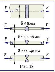
расчет выполняют по нормальным напряжениям подобно расчету любого элемента на продольную силу, и условие прочности стыкового шва имеет вид:
