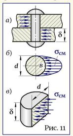
стические деформации и, как результат, может произойти смятие ее цилиндрической части, а также смятие стенок отверстия листов. В результате плотность прижатия листов нарушается, происходит расстройство соединения и вероятность среза заклепки многократно возрастает. Поэтому для заклепок обязательным также является расчет на смятие.
