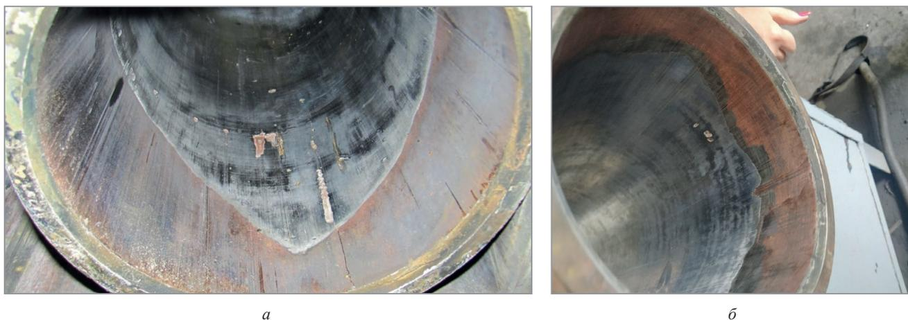
Рис. 4. Износ защитного покрытия гильз кристаллизаторов:
