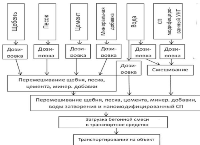
Рисунок 4.1 – Принципиальная технологическая схема приготовления бетонной смеси-матрицы с углеродным наноматериалом
