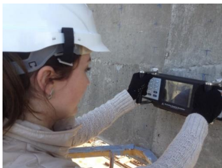
Рисунок 5.5 – Многоэлементная антенная решетка с привязкой к координатной оси
