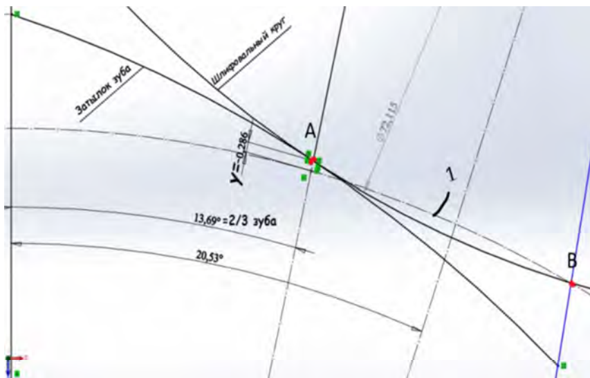
Рис. 9.17. Расчетная схема для определения влияния седлообразности на работу максимально сточенной фрезы:
