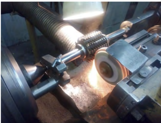
Рис. 4.2. Затылование червячной фрезы цилиндрическим шлифовальным кругом с заправленным профилем на токарно-затыловочном станке
