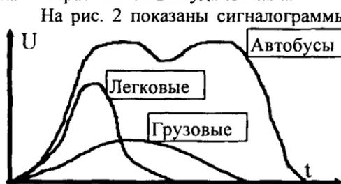
Рис.2 Сигналограммы различных транспортных средств
