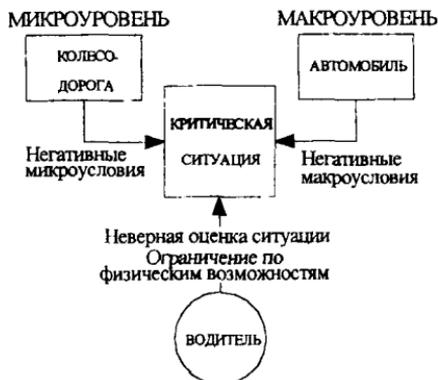
Рис. 1. Связь критической ситуации с системой "водитель - автомобиль - колесо - дорога"
