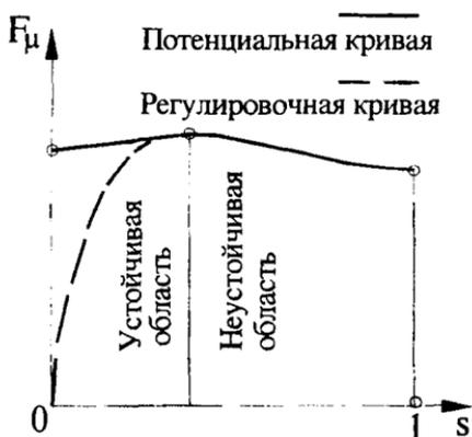
Рис. 2. Изменение потенциальной и текущей силы в контакте колеса с дорогой в зависимости от относительного проскальзывания
