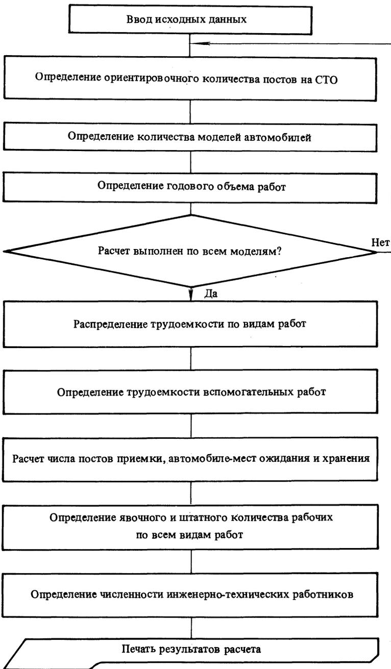
Рис. 1. Укрупненная схема алгоритма технологического расчета СТО
