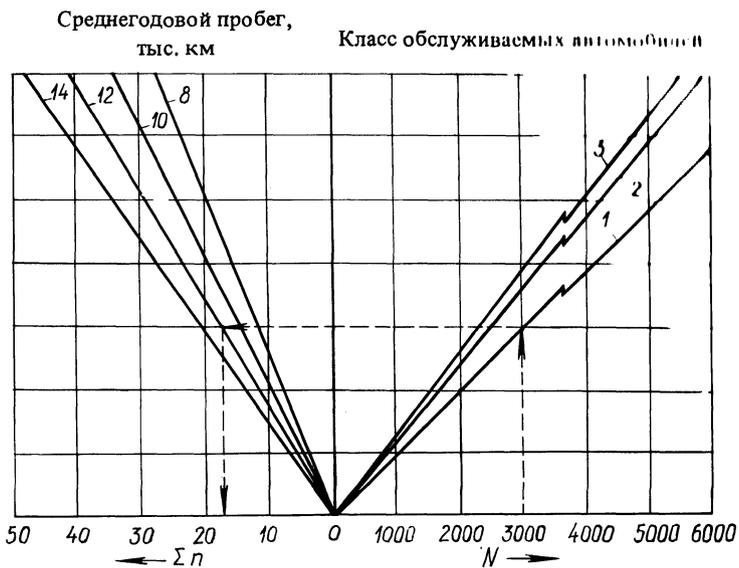
Рис. 2. Номограмма для определения суммарного числа постов на СТО (1 —автомобилья особо малого класса, 2 — малого, 3 — среднего)
