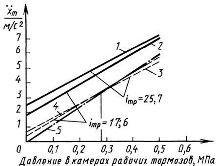
Рис. 1. Зависимость замедления трактора Т-150К от давления в тормозных камерах, передаточного числа трансмиссии и тормозного момента двигателя: 1, 2 – совместное торможение при  $M_{м.т} = 0,55 \text{ кН}\cdot\text{м}$ ; 3, 4 – совместное торможение при  $M_{м.т} = 0,15 \text{ кН}\cdot\text{м}$ ; 5 – торможение рабочими тормозами
