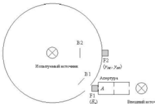
Рисунок 1 — Принцип измерения светового потока абсолютным методом
