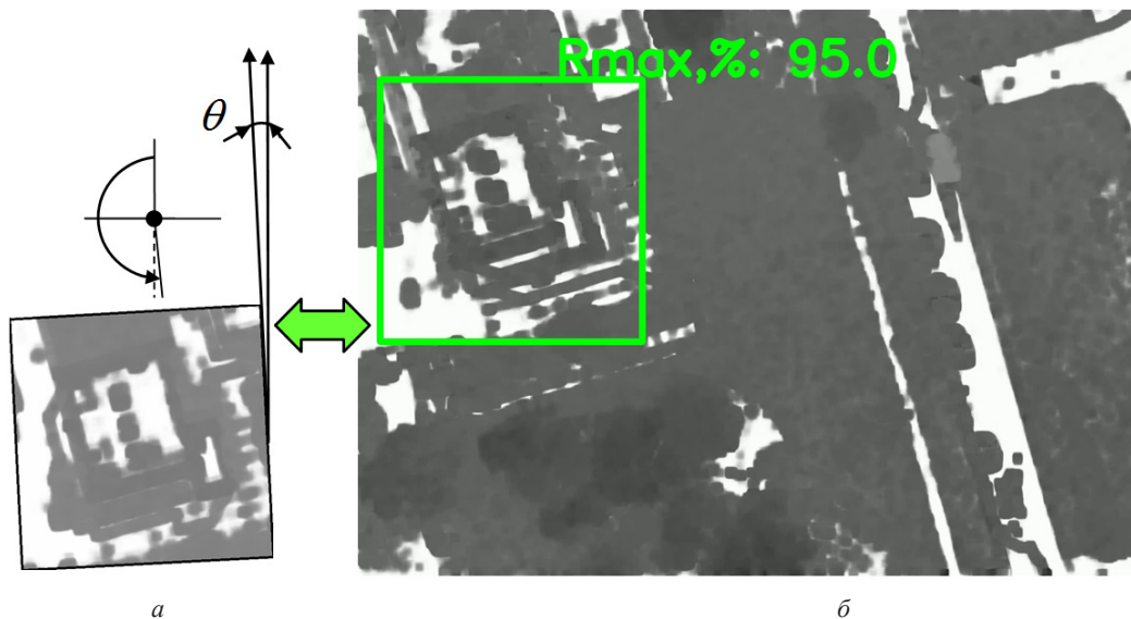
Рисунок 6. Результаты корреляционной обработки ЭМ и ТМ: a – исправленная ЭМ; б – обработанный кадр ТМ
