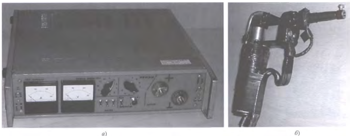
Рис. 1. Установка ГБФ-3 (а) и электромеханический вибратор (б)
