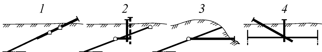
Рисунок 1.8 – Классификация (а) и графическая интерпретация (б) способов вскрытия шахтных полей
