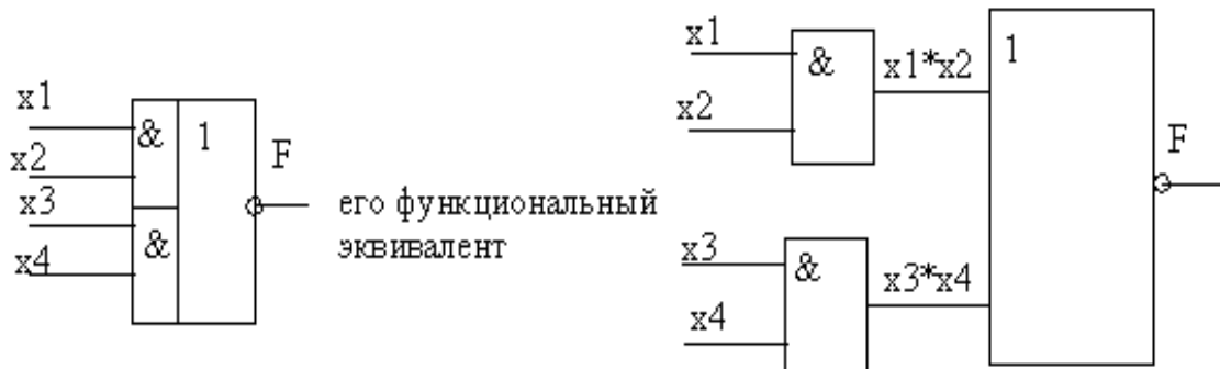
Рисунок 15.8 Условное обозначение и функциональный эквивалент элемента «2И-ИЛИ-НЕ»
