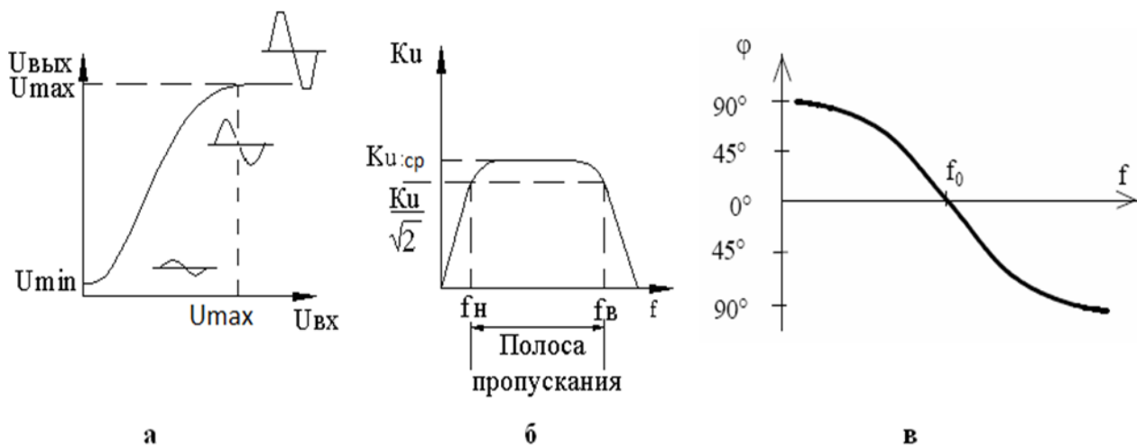
Рисунок 10.2 Характеристики усилителя: а – амплитудная; б – амплитудно-частотная; в – фазо-частотная
