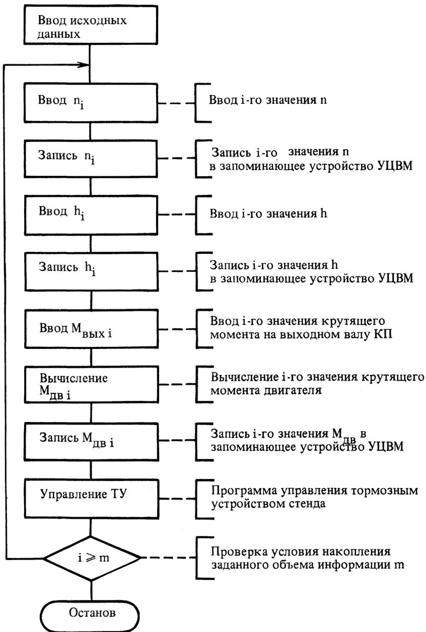
Рис. 1. Алгоритм работы управляющей цифровой вычислительной машины стенда.
