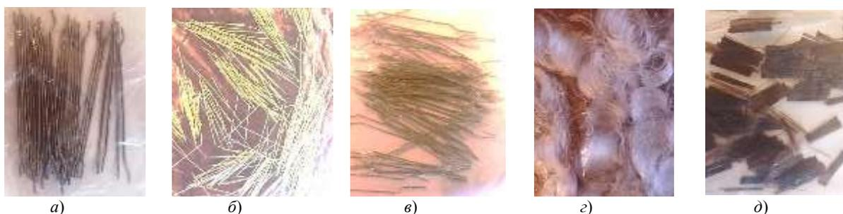
**Рис. 1. Фибровое волокно:** а – фибра стальная анкерная; б – микрофибра стальная прямая; в – микрофибра стальная анкерная; г – фибра полипропиленовая; д – фибра базальтовая
