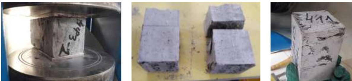
Рис. 5. Испытание половинок балочек на сжатие
