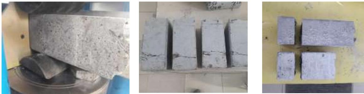
Рис. 7. Испытание половинок балочек на растяжение при раскалывании
