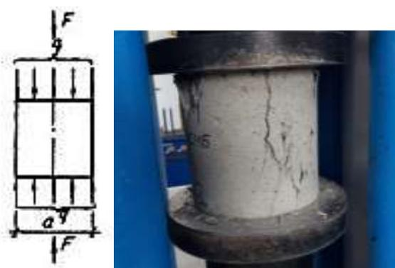
**Рис. 10. Схема испытания образцов-цилиндров на сжатие**
