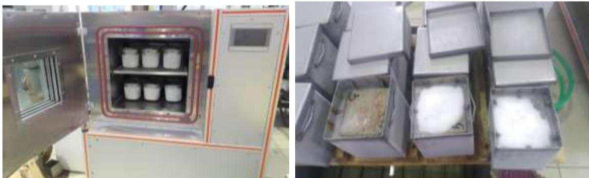
Рис. 5. Испытание бетонных образцов на морозостойкость
