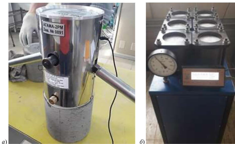
Рис. 6. Испытание бетонных образцов на водонепроницаемость:
