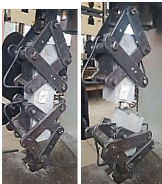
Рис. 7. Испытанные на осевое растяжение образцы призмы 70×70×280 мм
