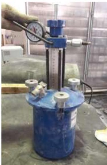
Рис. 2. Прибор поромер КП-133
