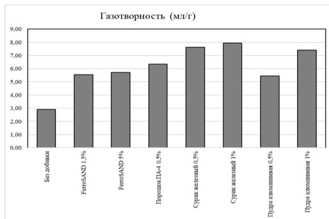
Рисунок 3 - Сравнительные результаты проверки стержневых смесей на газотворность.
