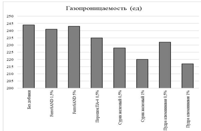
Рисунок 2 - Сравнительные результаты определения газопроницаемости смесей
