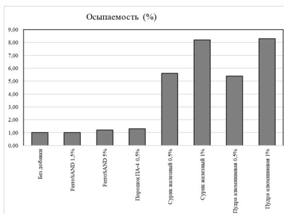
Рисунок 4 - Сравнительные результаты проверки стержневых смесей на осыпаемость.
