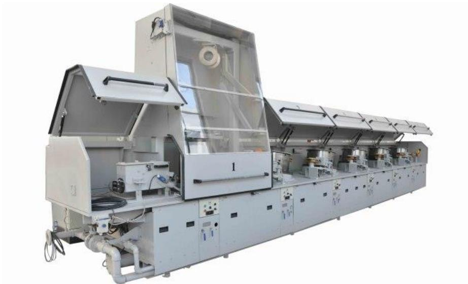
Рисунок 4 – Прямоточный волочильный стан с программным управлением
