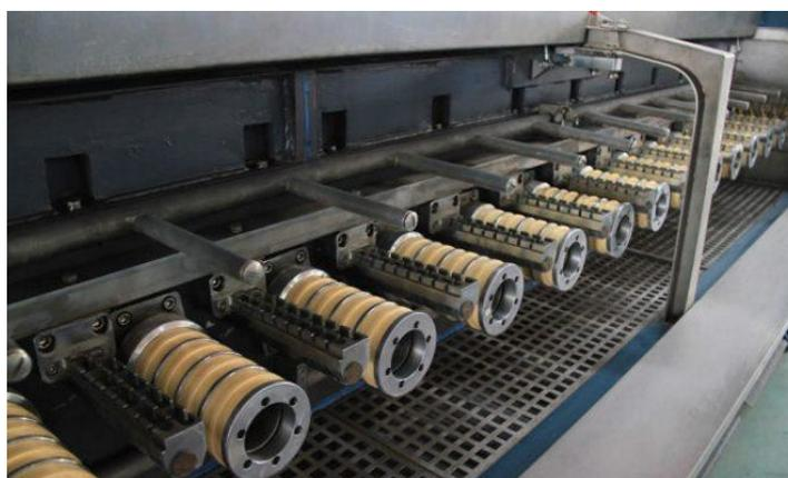
Рисунок 5 – Многониточный волочильный стан
