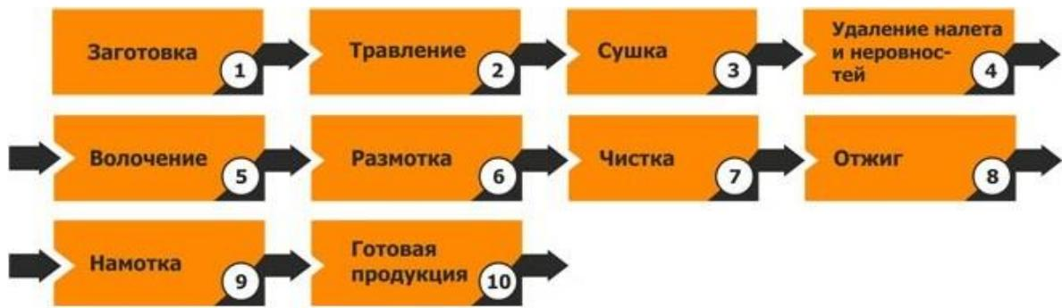
Рисунок 2 – Технологическая схема волочения проволоки из нержавеющей стали
