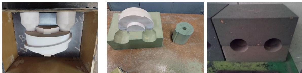
Рисунок 2 – Модельная оснастка (а), полуформа (б) и готовая стержневая форма (в).
