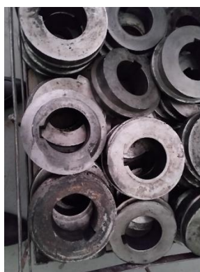
Рисунок 3 - Отработанные «шнеки» из высокохромистого чугуна в качестве основной шихты
