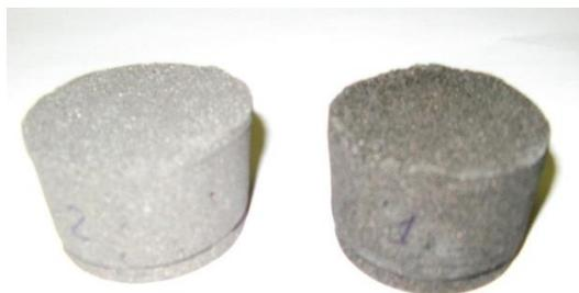
Рисунок 3 – Внешний вид брикетов из пылевидных отходов, полученных в результате отсева при производстве литой дробы, где в качестве связующего использовали натриевое жидкое стекло
