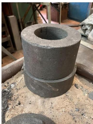
Рисунок 5 – Внешний вид графитовой формы
