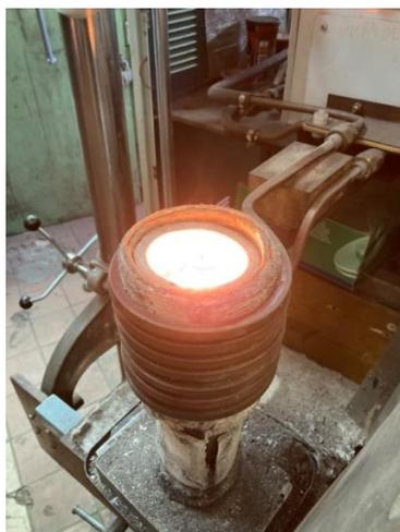
Рисунок 4 – Лабораторная индукционная печь ёмкостью 2,5 кг
