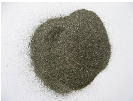
Рисунок 1 – Внешний вид пылевидных отходов газоочисток, полученные в результате отсева литой чугунной дроби и её помола (колки)
