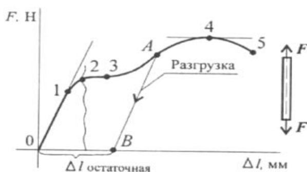
Рисунок 4 – График зависимости между приложенной силой и деформацией при растяжении
