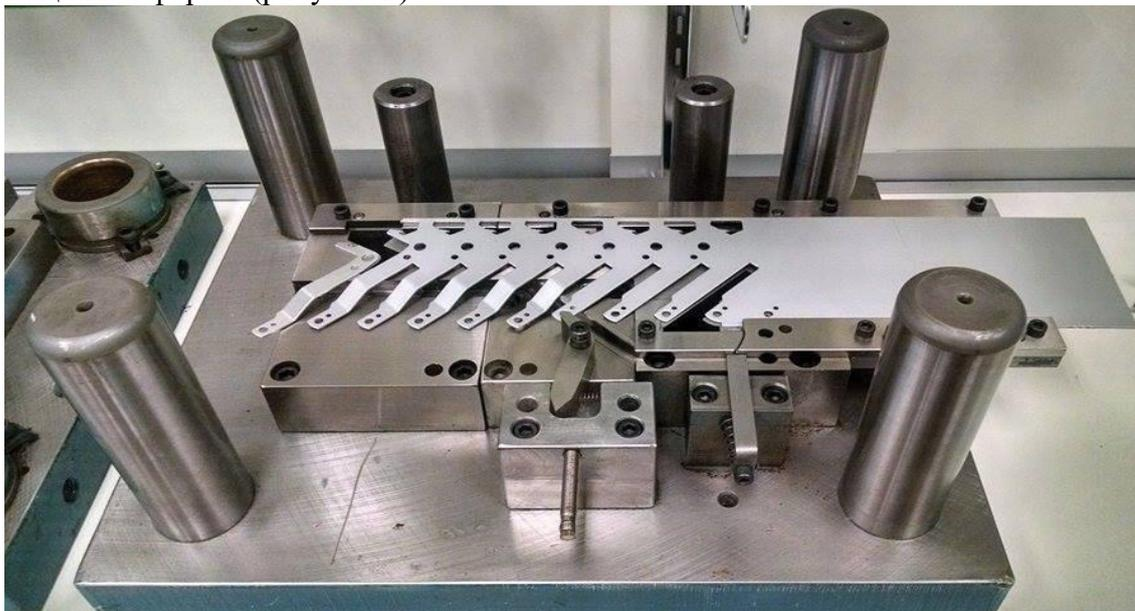
Рисунок 2 – Процесс прецизионной листовой штамповки
